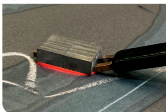
Rovnění materiálu o tloušťce 40 mm
